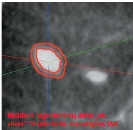
■ Abb. 2a/b: SNR bei Niedrigdosisprotokoll (II) Synthetischer Rundherd im Thoraxphantom
