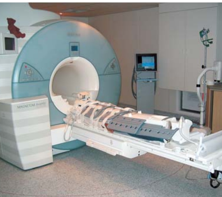
■ Abb. 1: Patient im MRT (Magnetom Avanto / Siemens, 1,5 Tesla) vorbereitet für die Untersuchung. Um den Patienten sind entsprechend der Körperabschnitte sogenannte Spulen (Antennen) angebracht, um die Signale aus dem gesamten Körper zu empfangen.
